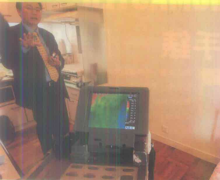
紅外線掃描器可快速探測牆身表面的溫差，間接評估濕度。但紅外線並不適用於表面光滑及光亮的建材，如磁磚、膠磚、石面等。
